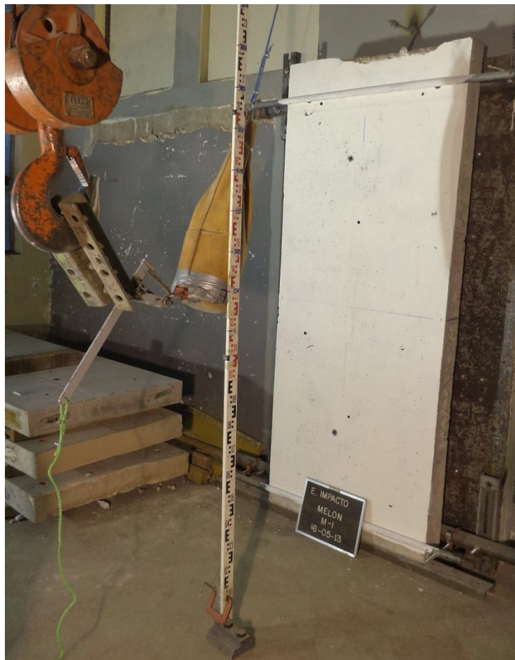
Fotos 1. Montaje del ensayo de impacto de cuerpo blando al panel (típico).
