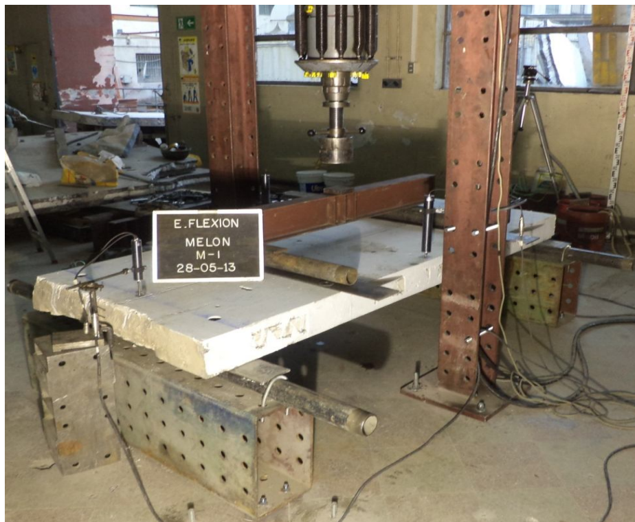
Foto 1. Montaje del ensayo de flexión (típico).
