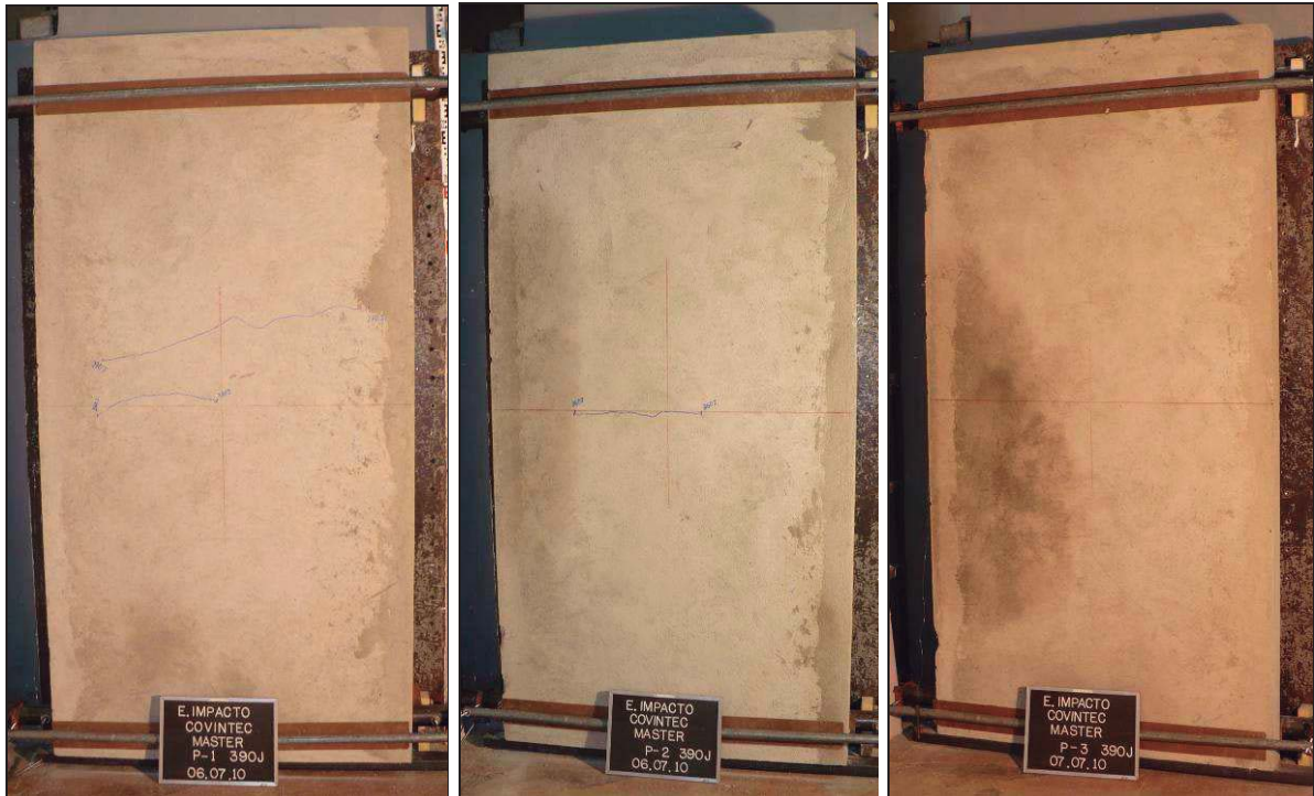
Fisuras transversales en cara de impacto, media altura del panel.
