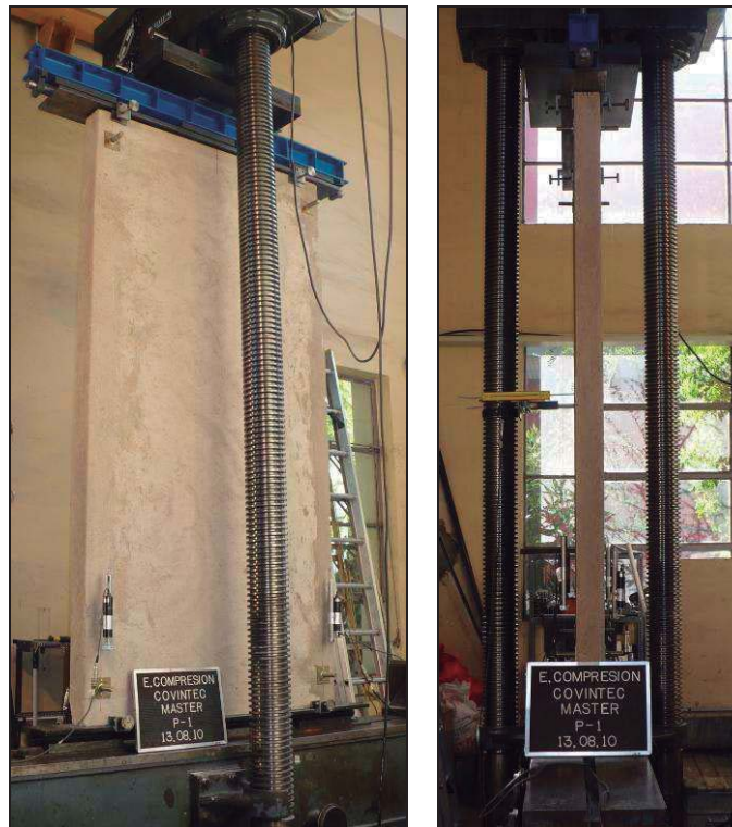
Fotos 1 y 2. Vista general del montaje del ensayo de compresión excéntrica al panel.
