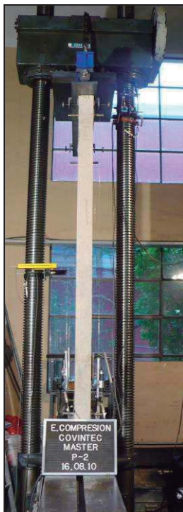
Fotos 5 y 6. Modo de falla del panel Nº2. Falla por aplastamiento en el borde inferior.
