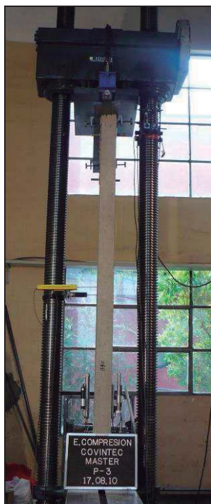
Fotos 7 y 8. Modo de falla del panel Nº3. Falla por aplastamiento en el borde superior.
