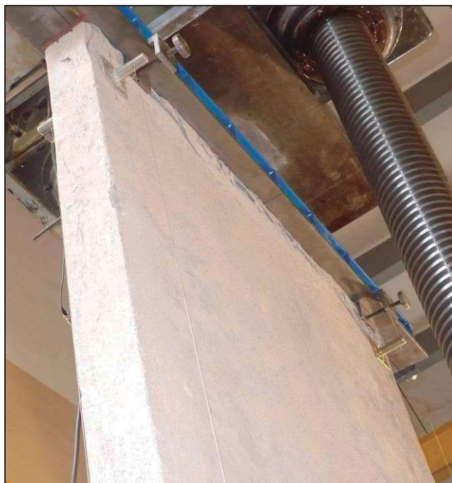
Fotos 7 y 8. Modo de falla del panel Nº3. Falla por aplastamiento en el borde superior.
