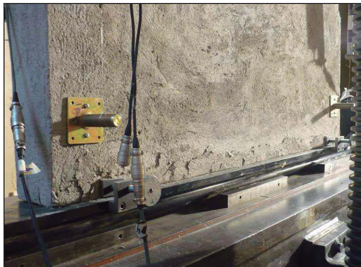
Fotos 5 y 6. Modo de falla del panel Nº2. Falla por aplastamiento en el borde inferior.
