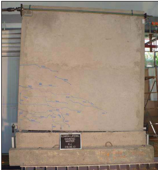
Fotos 4 y 5. Modo de falla de la muestra Nº 1. Falla de adherencia de las barras de anclaje del panel.
