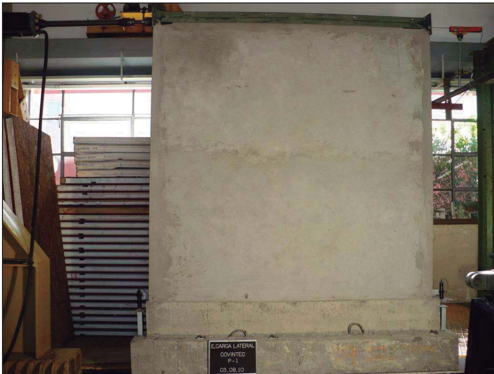
Foto 3. Vista general del montaje del ensayo de carga horizontal al panel.
