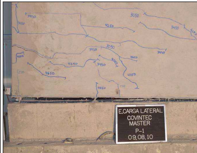
Fotos 4 y 5. Modo de falla de la muestra Nº 1. Falla de adherencia de las barras de anclaje del panel.
