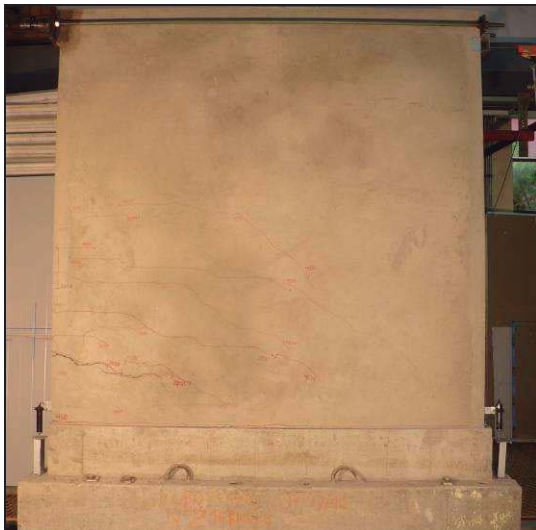
Fotos 6 y 7. Modo de falla de la muestra Nº 2. Falla del revestimiento de mortero por flexo-tracción.
