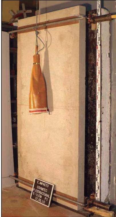
Foto 1. Montaje del ensayo de impacto de cuerpo blando al panel (típico).
