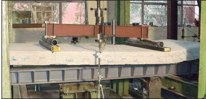
Fotos 6 y 7. Modo de falla del panel n° 1.
