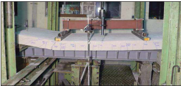
Fotos 8 y 9. Modo de falla del panel n° 2.
