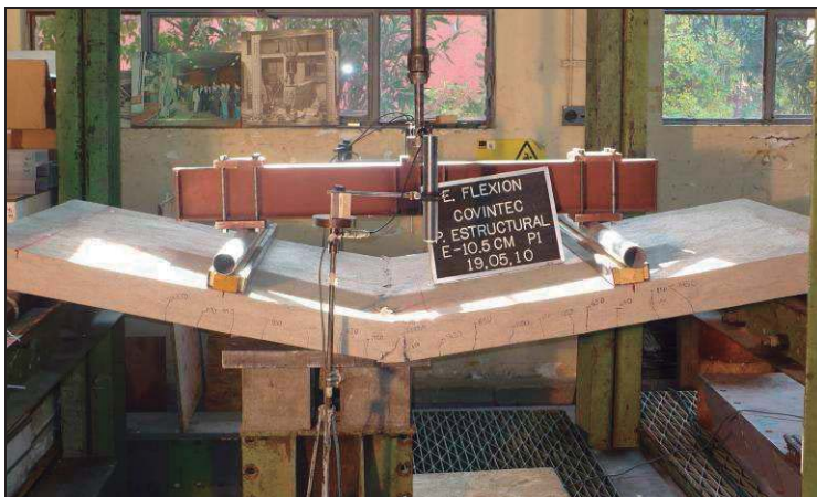
Fotos 2 y 3. Modo de falla del panel (falla típica).
