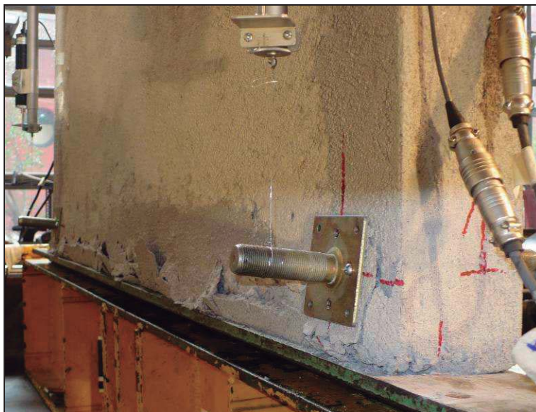
Fotos 5 y 6. Modo de falla del panel Nº2. Falla por aplastamiento en el borde inferior.
