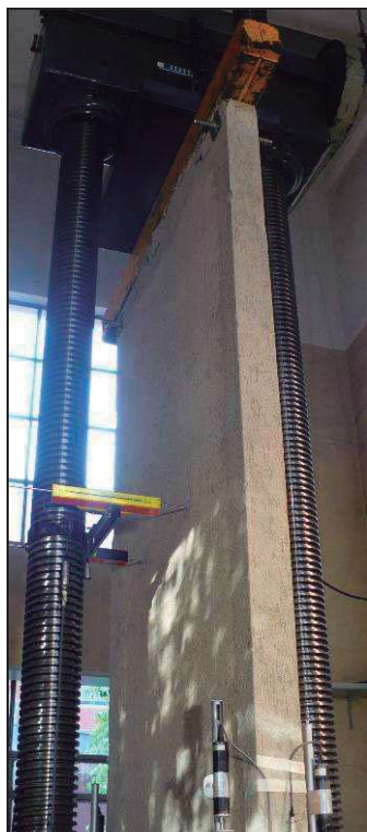
Fotos 7 y 8. Modo de falla del panel Nº3. Falla por aplastamiento en el borde superior.
